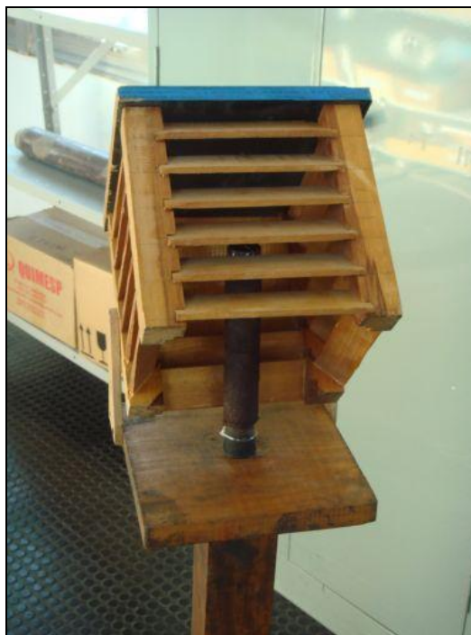
Fig. 29 – Instalação da vela de sulfato no painel fixada no painel preparado para ser colocada na área.
