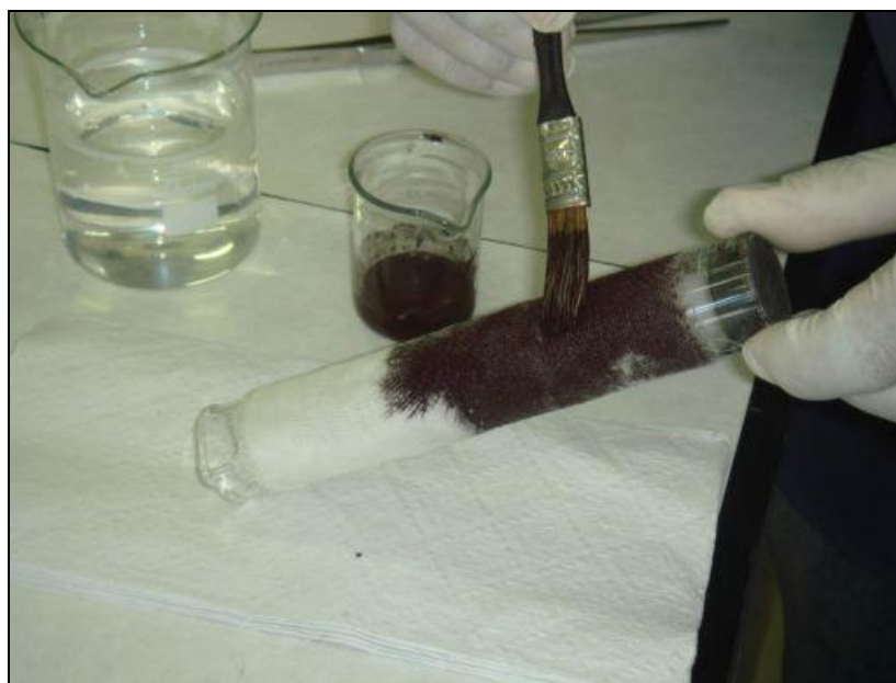
Fig. 25 – Recobrimento das camadas de gaze cirúrgica com a pasta de dióxido de chumbo.
