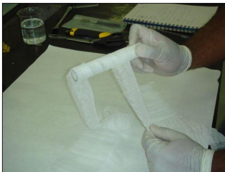
Fig. 6 – Início da preparação da vela úmido, consistindo em envolver com gaze cirúrgica um cilindro de vidro.
