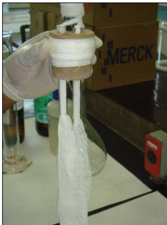
Fig. 9 – Aspecto do dispositivo de fixação de cloreto após ter sido instalada a gaze na rolha
